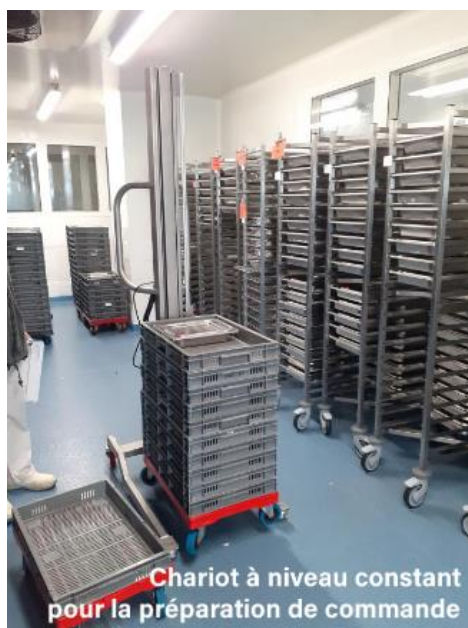
Image 2 : Chariot à niveau constant pour la préparation de commande
