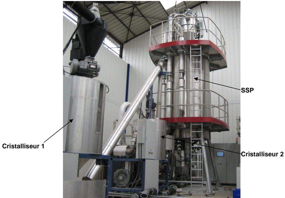
**Figure 7: Unités de Cristallisation et Polycondensation à l'état solide, ligne 1**
