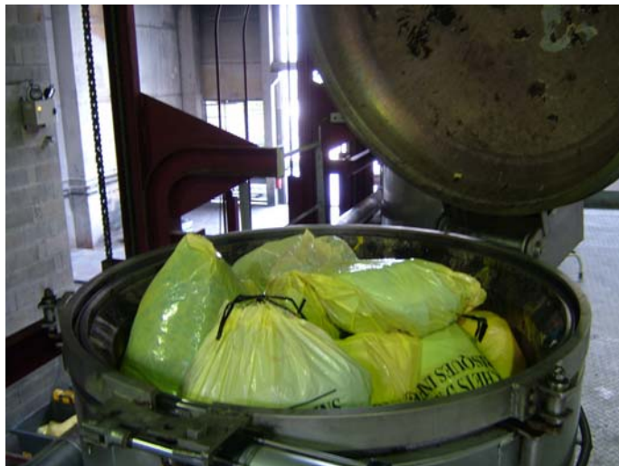
Les déchets sont broyés puis stérilisés par vapeur d'eau à 138°C avec une pression de 4 bars. La durée totale du cycle est de 40-45 minutes
