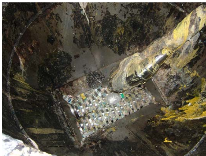
Le broyeur est tout inox afin de résister aux contraintes exercées par la vapeur.
