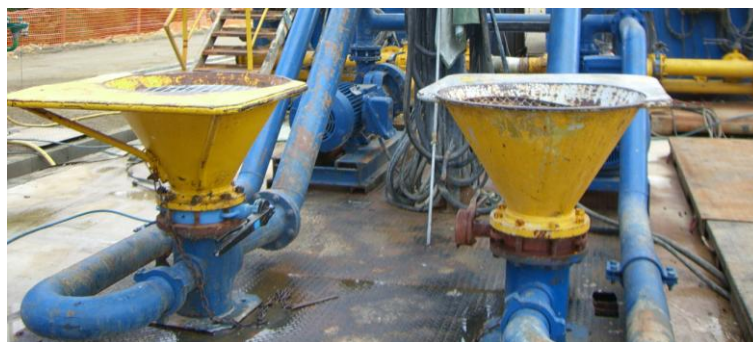
Figure 10 : Photographie de la mixing area localisée à côté des bassins à boue sur un rig à terre (rig SMP5, Lussagnet, France)
