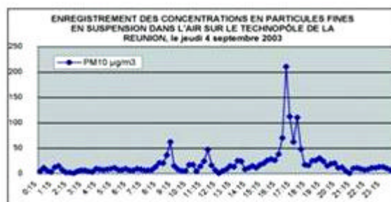
Figure 3 Impact d'un feu de canne sur la qualité de l'air à proximité Source: ORA
