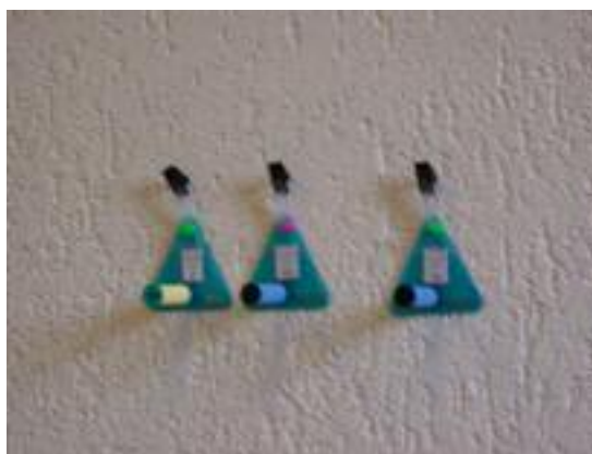
Illustration des 3 types de tube à diffusion
