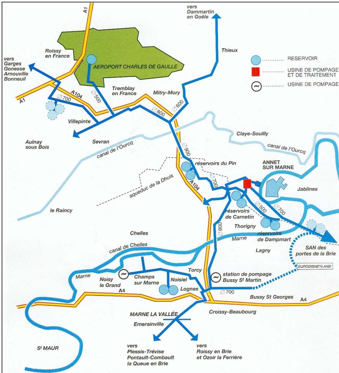
**Figure 34 : schéma du réseau de la SFDE**
