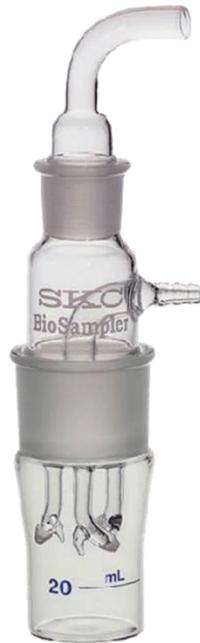
Figure 1-6 : Photographie d'un Biosampler SKC
