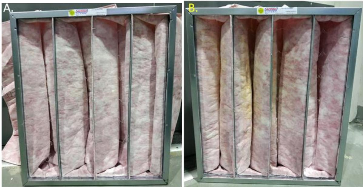
*Figure 2-13 : Photographie des filtres après génération de fluorescéine*
