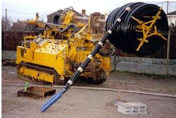
**Figure 7 : Exemple de sonde géothermique verticale**
