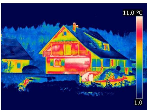
Sur cette image thermique, on constate que les murs sont non isolés avec des déperditions thermiques importantes (en rouge).
