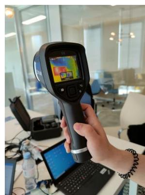
Photo 2 : Caméra thermique FLIR E8
