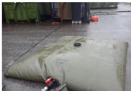
Bache de récupération des eaux contaminées
