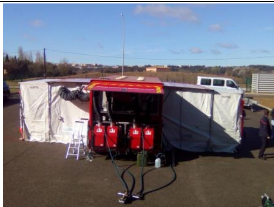
Unité complètement installée (entrée d'un côté et sortie de l'autre côté, avec la douche au centre)
