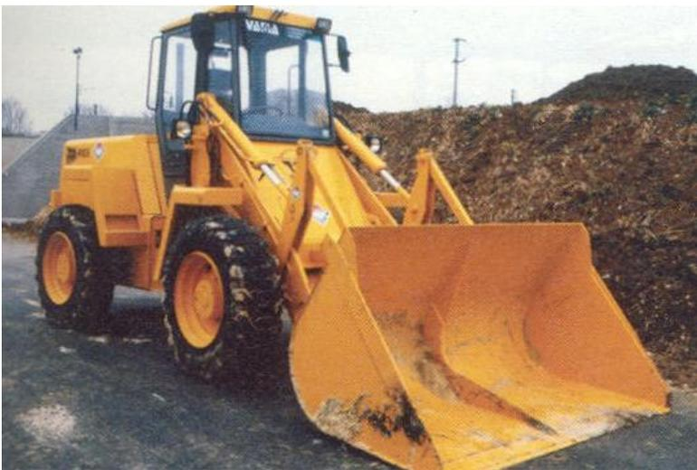
**Image 7. Chargeuse sur pneus [8].**
