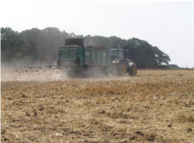
**Image 26. Épandage de boues pâteuses presque solides avec épandeur à hérissons horizontaux (photo personnelle).**
