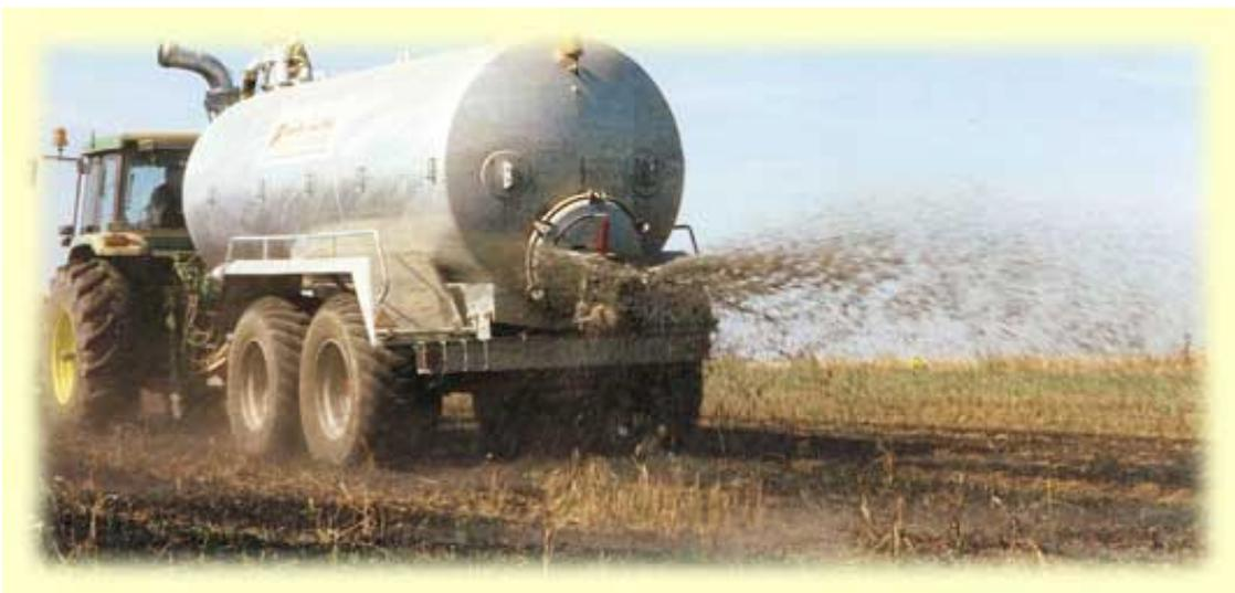
**Image 15. Épandage par tonne à lisier et buse unique.**
