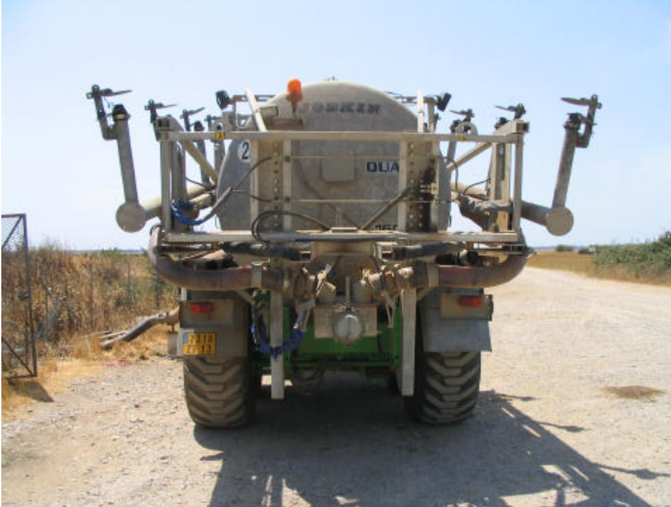
**Image 14. Tonne à lisier avec rampe repliée (photo personnelle).**
