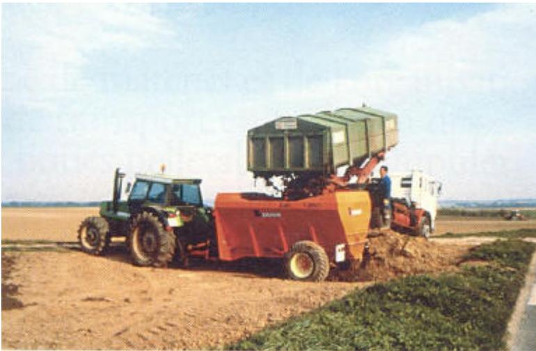
**Image 12. Déversement d'une remorque directement dans l'épandeur [8].**
