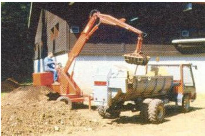
**Image 11. Grue semi-portée, autonome au travail mais déplacée d'un point à l'autre par le tracteur [8].**
