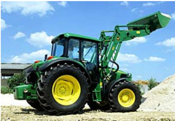
**Image 4. Chargeur frontal à deux bras monté sur un tracteur agricole (source : [www.deere.com/fr\\_FR/products/equip\\_ag/tractors/6020SE/cha.html](http://www.deere.com/fr_FR/products/equip_ag/tractors/6020SE/cha.html)).**
