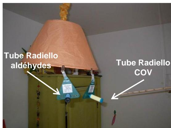
Figure 6: Prélèvement des aldéhydes et des COV dans l'air de la chambre
