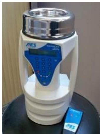
Figure 8: Bioimpacteur utilisé pour le prélèvement des moisissures dans l'air
