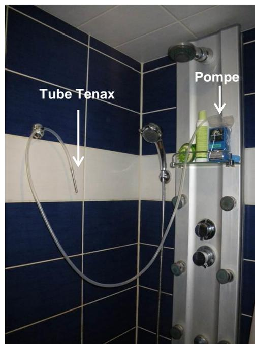
Figure 5: Prélèvement des THM dans l'air de la cabine de douche
