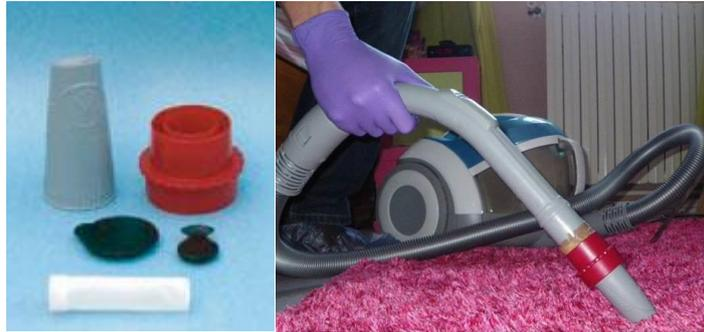
Figure 9: Kit Dustream collector (à gauche) et prélèvement des poussières sur le sol de la chambre (à droite)
