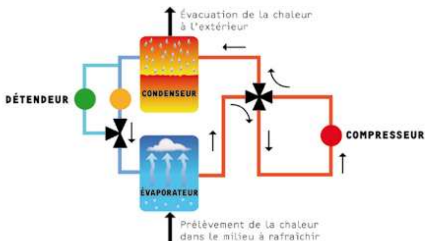
Figure 1 : Schéma de fonctionnement d'une PAC réversible en Été.
