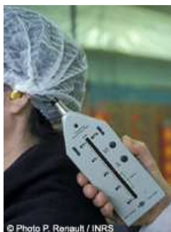
Figure 8 : placement du sonomètre pendant la mesure
