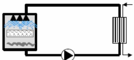
**Tour ouverte + échangeur non accolé** : un échangeur à plaques intermédiaires est disposé entre le circuit à refroidir et le circuit de la tour équipée d'un corps d'échange. Le fonctionnement de la tour est identique à celui d'une tour ouverte avec un circuit d'eau indépendant.
